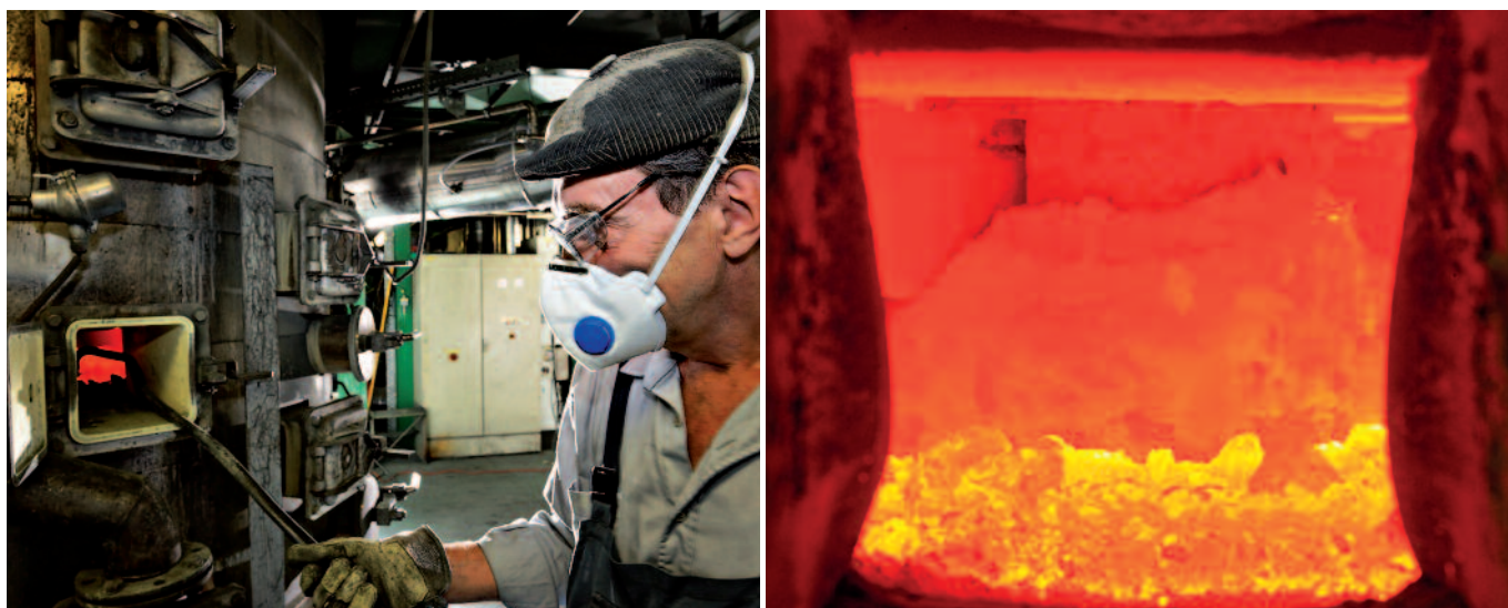
Figure 12: Multiple hearth furnace for oxidation of tungsten scrap. Courtesy of Wolfram Bergbau und Huetten AG
